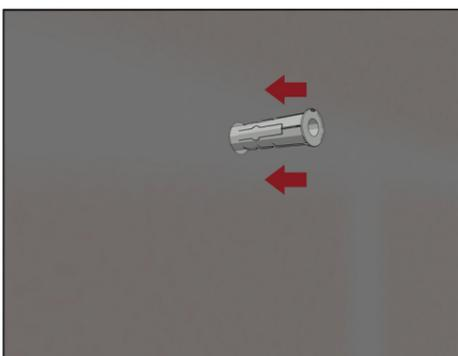
Dübel in die Bohrlöcher setzen.
