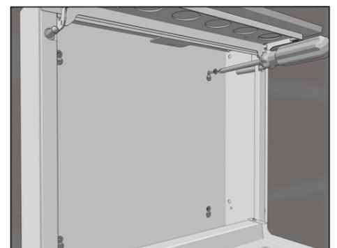
Den Briefkasten mit Hilfe der 4 rückseitigen Löcher auf die Schrauben hängen und anschließend die Schrauben mit einem TX20 Torx Schraubendreher anziehen.
