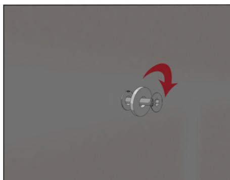
Schrauben in die Dübel schrauben, jedoch diese noch nicht ganz anziehen. Ein Abstand von ca. 5-7 mm frei lassen.
