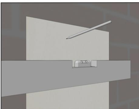
Bohrschablone mit Hilfe der Wasserwaage grade ausrichten und Markierungen für die Bohrlöcher setzen.
