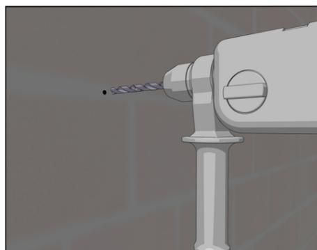
Bohrlöcher mit Hilfe der Bohrmaschine und einem 8er Bohrer bohren.
